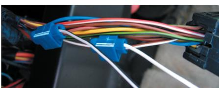
Durch Querverbinder hergestellte Verbindung
