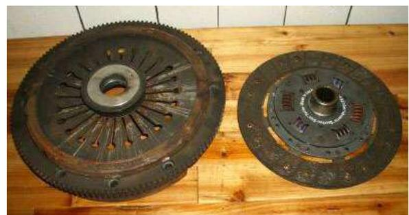
verstärkte Kupplungsscheibe mit einem Torsionsdämpfer aus Stahlfedern und nicht die Gummiversion verwenden - diese wird sich wie bei meinem und vielen anderen Fahrzeugen in absehbarer Zeit wieder selbst zerlegen.
