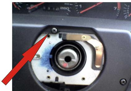
Als nächstes die 3 Schrauben lösen und den Zierkranz entfernen.
