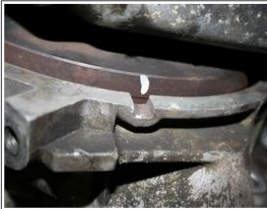
8. Demontage des Anlassers, um an dessen Stelle das in den Bildern dargestellte Sonderwerkzeug zum Blockieren der Kurbelwelle einzusetzen. (Falls dieses Werkzeug nicht zur Hand ist, kann auch eine der M8 Inbus -Schrauben, welche den Kupplungsautomaten auf der Schwungscheibe halten, entfernt und gegen eine geeignete Gewindestange ersetzt werden)
