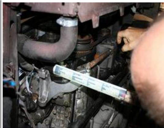
4. Zündkabel aus der Zündspule entfernen, Verteilerkappe demontieren ( 2 Bajonettverschlüsse beim 8-Ventiler, 3 Halteschrauben beim 16V) und die Zahnriemenabdeckungen abbauen ; (Achten Sie darauf, das keine Unterlegscheiben oder sonstiges in das Kunststoffgehäuse gerät)
