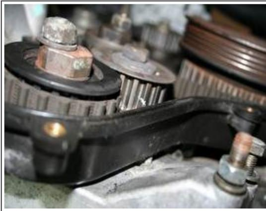
10. Achtung: grundsätzlich sollten alle Lauf- und Spannrollen immer ersetzt werden, des Weiteren empfiehlt sich eine Kontrolle der Wellendichtringe vor der Riemendemontage: sollten Ölleckagen festgestellt werden, müssen diese erst behoben werden, da sonst die neuen Zahnriemen schnell unbrauchbar werden
