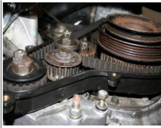
**Exenterschrauben wird ein 27er Maulschlüssel benötigt.**
