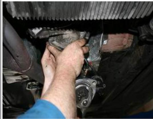
23. Die Kurbelwelle mit einem 24er Steckschlüssel zwei komplette Umdrehungen im Uhrzeigersinn durchdrehen > alle Markierungen müssen jetzt wieder fluchten (zwei Kurbelwellendrehungen bewirken eine Nockenwellendrehung 360°.)
