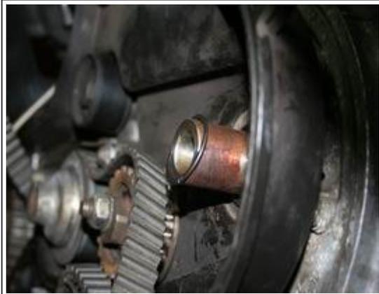
15. Zahnrad der Kurbelwelle wird wieder montiert ( Kurbelwellenzapfen vorher etwas polieren und mit Kupferpaste oder Molycote bestreichen ( verhindert festfrieren)
