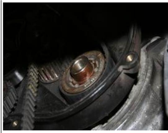
16. der Zahnriemen wird aufgelegt: Achtung der Zugtrum des Riemens sollte straff anliegen ( Zugtrum: direkte Verbindung des Nockenwellenrades mit dem Kurbelwellenrad/ die KW zieht die NW).
