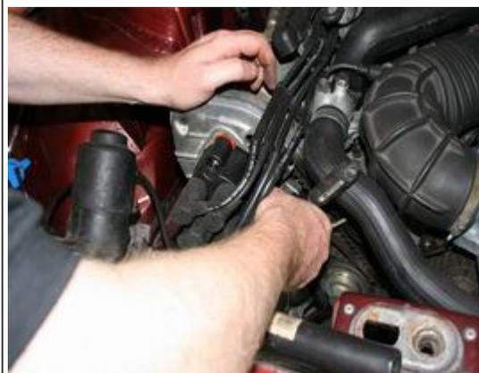
5. der Riementrieb ist freigelegt, jetzt kann der Motor, durch drehen an der Kurbelwelle, auf die Nullpunktstellung ( OT 1 Zylinder; OT: oberer Totpunkt Kolben ist auf dem höchsten Punkt, Einlass- und Auslassventile sind geschlossen; 1 Zylinder : der Zylinder, der sich gegenüber der kraftabgebenden Seite befindet, im Falle der Porsche 924 / 944/ 968/ 928 der vorderste in Fahrtrichtung) gebracht werden
