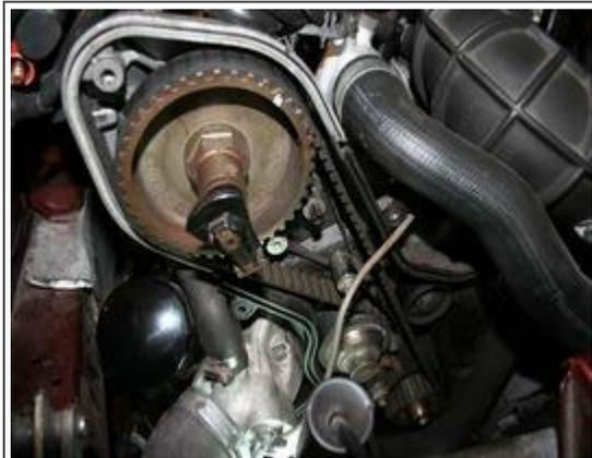
18. Auf dem Bild wird die Verlegung des Doppelrippriemens für die Ausgleichswellen gezeigt;
