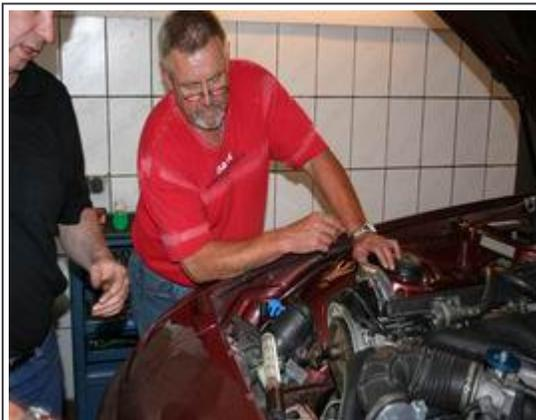
6. mit einem 24er Steckschlüssel wird die Kurbelwellenschraube solange im Uhrzeigersinn gedreht, bis sich die Markierung auf dem Nockenwellenrad in einer Flucht mit der Markierung auf dem Gehäuse befindet ( das vorherige Entfernen der Zündkerzen erleichtert diese Arbeit, da nicht gegen die Kompression des Motors gedreht werden muss; immer im Uhrzeigersinn drehen, niemals entgegengesetzt;)
