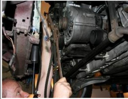
14. der Dichtring der Ölpumpe wird ersetzt
