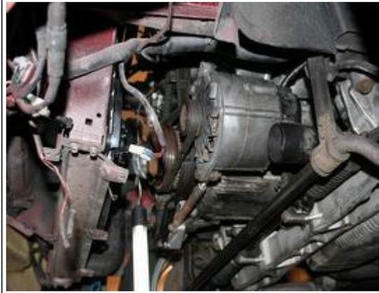
3. Spannstange Servopumpe und Spanner Lichtmaschine entspannen und danach demontieren ( Achtung: beide Spannvorrichtungen haben jeweils ein Rechts- und ein Linksgewinde)
